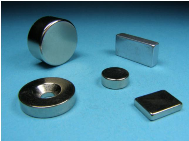
NdFeB-Magnete gehören zur Gruppe der Seltenen-Erden und somit zu den Hochenergiemagneten. Die Verfügbarkeit der Ausgangsrohstoffe ist relativ gut und das Magnetprodukt daher preisgünstiger als im SmCo-Bereich (S.10). NdFeB-Magnete sind sehr hart, aber weniger spröde als SmCo-Magnete. Sie werden heute in nahezu allen Anwendungen eingesetzt, weil sich auf Grund ihrer hohen Energiedichte Systeme wie Lautsprecher oder Motoren deutlich kleiner und leistungsfähiger
